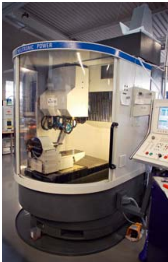
Die Helitronic Power mit Production-Paket setzt Ritzhaupt zur Fertigung größerer Werkzeugserien ein
