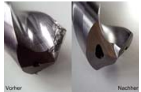
Durch Nachschleifen lässt sich die ursprüngliche Werkzeugqualität wiederherstellen Bild: Ritzhaupt
